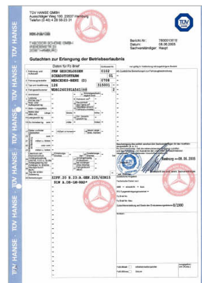
Gutachten des TÜV Hanse GmbH zur Erlangung der Betriebs-erlaubnis für Bereifung 225/60 R 15 91 W auf Original-Leichtmetallfelge 7Jx15H2 ET25 an einem 560 SEL (279 PS, Vmax 240 km/h).
