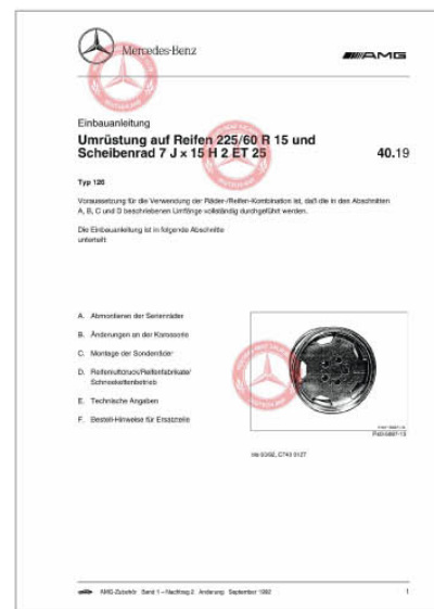
Einbauanleitung für die Umrüstung auf Reifen 225/60 R 15 und Scheibenrad 7Jx15H2 ET25 (auf WIS-CD enthalten).
